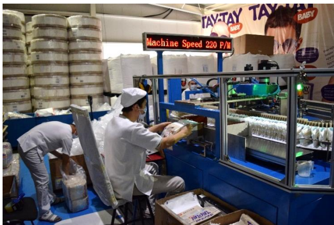
こちらが1分で最大500個の紙おむつを製造できるという機械 後景に見えるのが自社ブランド「TAY TAY」のパッケージデザイン
