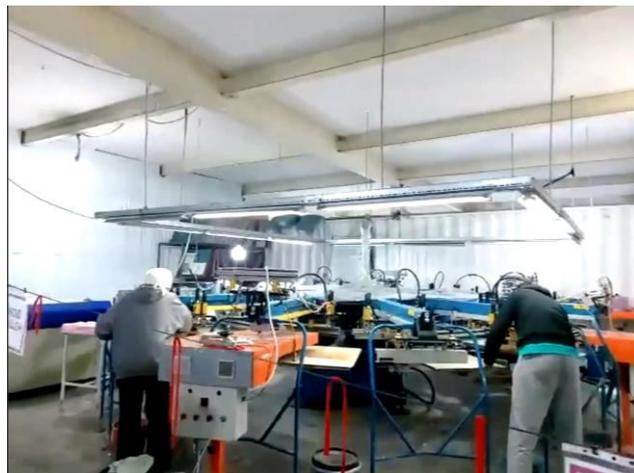
写真 10 : シルクスクリーン印刷機
